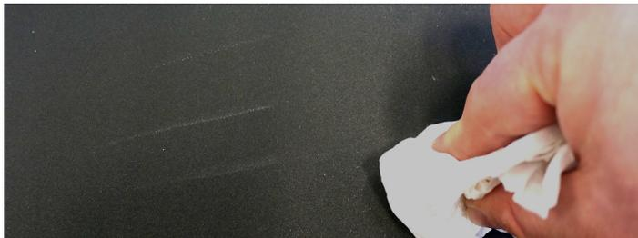
Die Strukturmittel auf PMH-Basis sind im Vergleich zu den meisten anderen Kunststoffen relativ hart. Dies führt zu hohen Oberflächenresistenzen und Schutzwirkung. Fingernägel beispielsweise führen zu keiner Beschädigung. Die Markierungsspuren sind reversibel.
