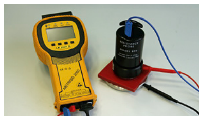
Messung des Durchgangswiderstands.
